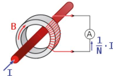
Die jeweilige mechanische Konstruktion der Wechselstrom-Stromwandler ist abhängig von der Spannungsebene und ermöglicht den Einsatz auf Leiterplatten innerhalb von Mess- und Schutzgeräten in sehr kompakten Bauformen und mit amorphen/nanokristallinen Kernen. Die Verwendung in der Hoch- und Mittelspannungsebene oder der Einsatz auf Stromschiene in Niederspannungsschaltanlagen oder als Stromgeber für mobile Energiemonitore zur Erfassung des selektiven Verbrauchs sind weitere Anwendungsbereiche.
